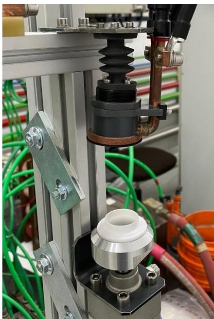
Ilustración 48. Ventosa fabricada en Flexa Performance, tecnología SLS
