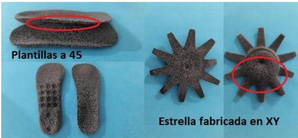
Ilustración 6. Pieza demostrador 1 Empresa Clínica Girones (Plantilla pequeña) a 45° y estrella espesores, con defectos
