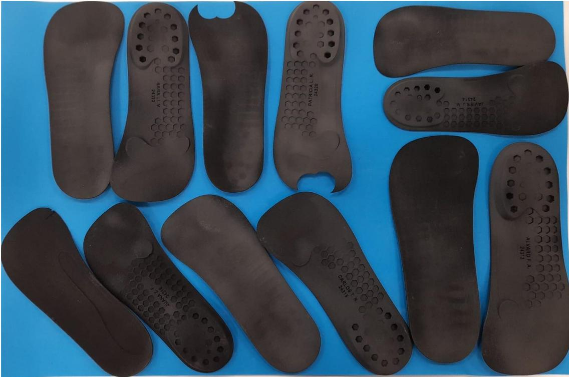
Ilustración 54. Plantilla obtenidas en una bandeja de fabricación ( 6 pares), donde se ven algunas con defectos.
