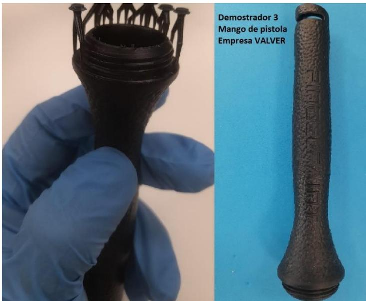
Ilustración 25. Pieza demostrador 3 para empresa VALVER, mango de pistola con soporte mejorado en parte roscada.
