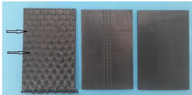
Ilustración 15. Placas fabricadas después del mantenimiento y con optimización de soportes, defecto reducido.
