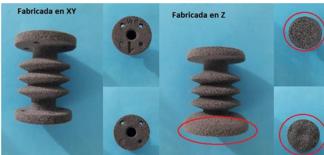
Ilustración 7. Piezas demostrador 1 Empresa GH Electrotermia (Ventosa) fabricadas en XY y en Z, con defectos
