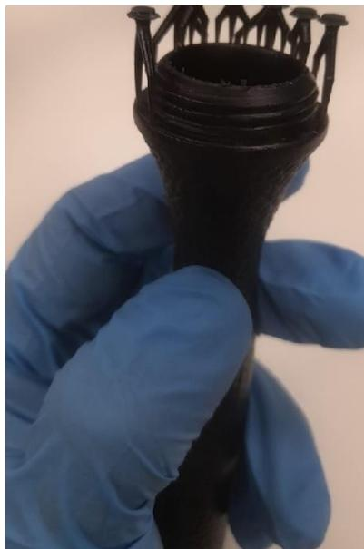
Ilustración 53. Mango de pistola con soportes mejorados y después de quitar los soportes, tecnología LCD, resina HARD.
