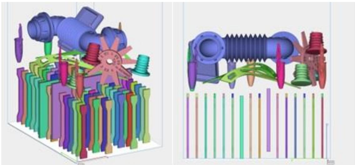
Ilustración 29. Bandeja de fabricación con probetas y lámina para caracterización tras envejecido
