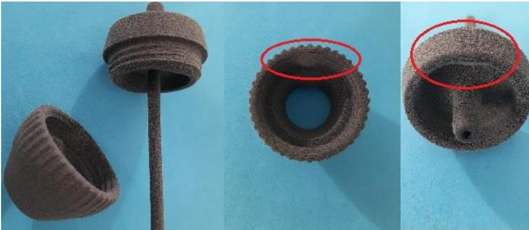
Ilustración 5. Pieza demostrador 1 empresa colaboradora VALVER (Pincel pequeño) fabricada en XY, con defectos
