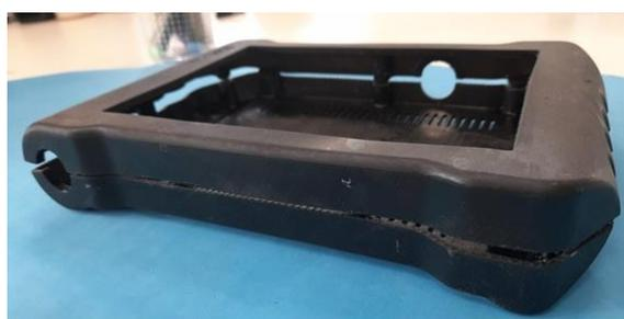
Ilustración 17. Pieza demostrador 2 GH Electrotermia, fabricado en la resina DL110HB
