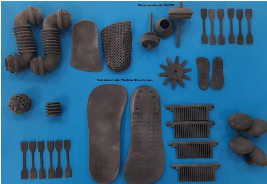
Ilustración 13. Piezas obtenidas en la bandeja de fabricación Material Flexa Performance, optimización 4
